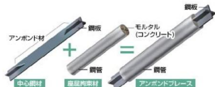
図-4 UBBの構造
