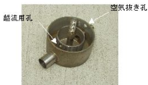
写Ⅱ-3-2 計測水槽内部
